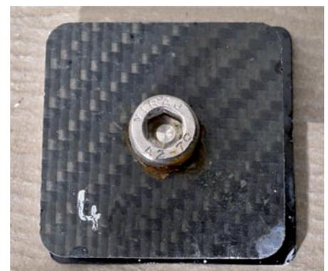
Abb. 3: CFK-Probekörper im Verbau mit einer M8-V2A-Schraube nach korrosiver Belastung
